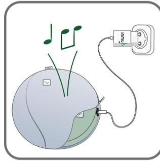
Finden Sie den Reißverschluss. Öffnen Sie den Überzug. Schließen Sie das Kabel und das Ladegerät an. Es ertönt ein Signal, das anzeigt, dass der Ladevorgang begonnen hat.
