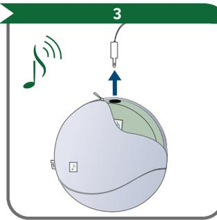
3. ... ziehen Sie das Kabel sofort wieder heraus, um die bevorzugte Einstellung zu speichern. Ziehen Sie den Reißverschluss wieder zu und verstecken Sie den Schiebergriff.
